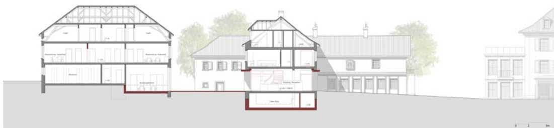
Schnitt Gästehaus und Engpassbereich C-C 1:100
