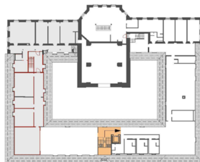
3.OG Arrestzellen während Umbau über Treppenhaus Nord erschlossen
